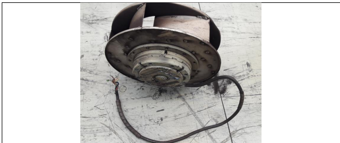
Fig. 5: Subconjunto Motor-ventilador – VENTILADOR Original
